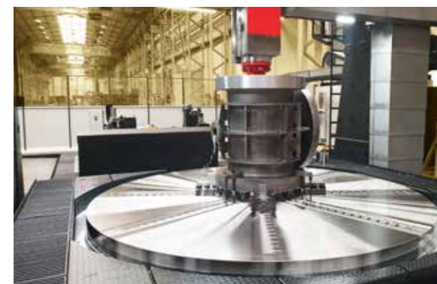
obrábění tělesa armatury
